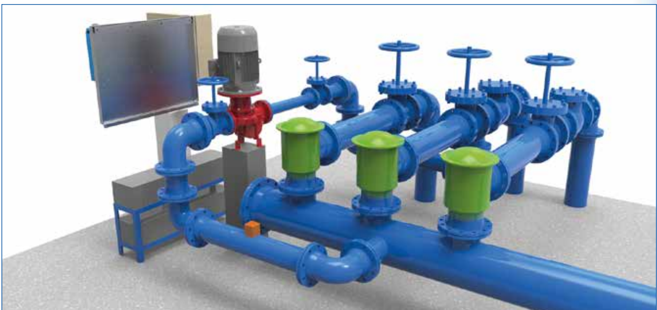
Esquema de la instalación de la PAT en by-pass en el hidrante.
